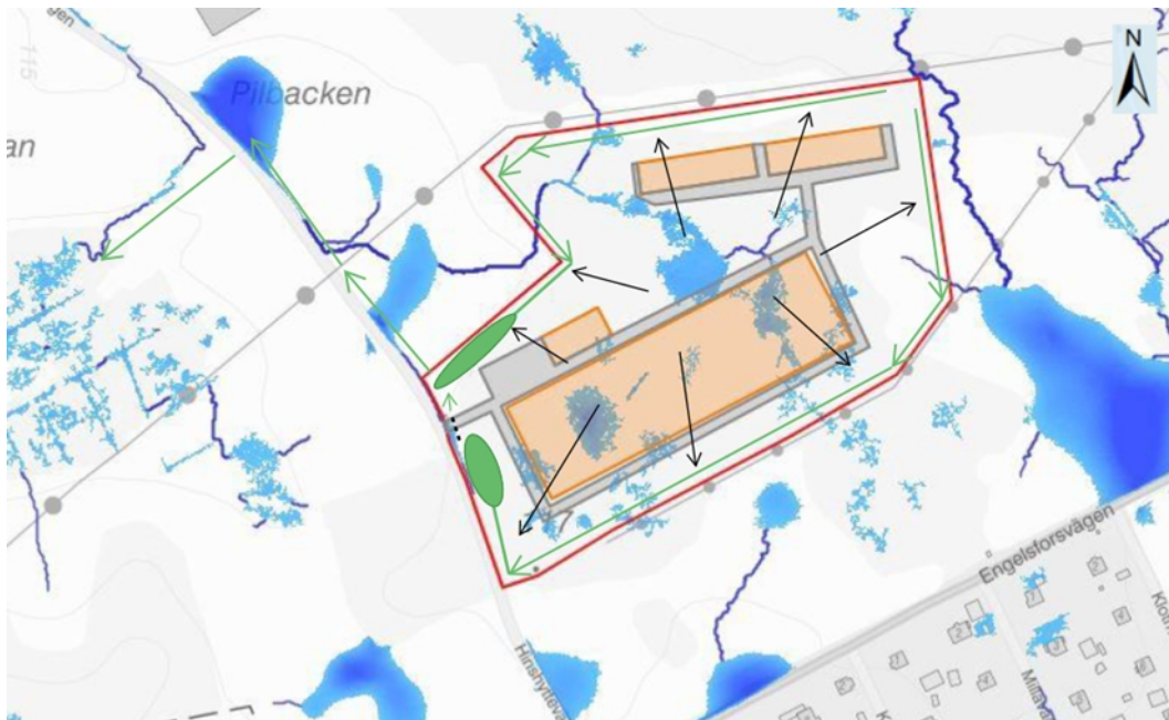
Principskiss över lösningförslag för dagvattenhantering efter exploatering.
