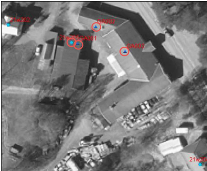
Figur 17. Provpunkter som inkluderats vid bedömningen avseende CAH i inomhusluft inringade med rött. Trianglar avser provpunkter från Hifabs undersökning 2011 (Hifab, 2012) och hexagoner avser provpunkter från WSP:s undersökningar 2021 (WSP, 2023). Utdrag från WSP:s rapport Riskbedömning Bernard Hedlund f.d. metallfabrik (WSP, 2024).
