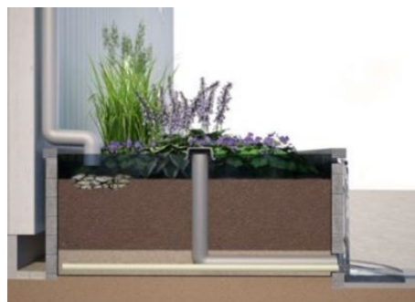
Bild 10: Exempel på upphöjd växtbädd som tar emot dagvatten från tak via stuprör. Bilderna är hämtade från Infrastrukturutredning Hedemora simhall, s.49
