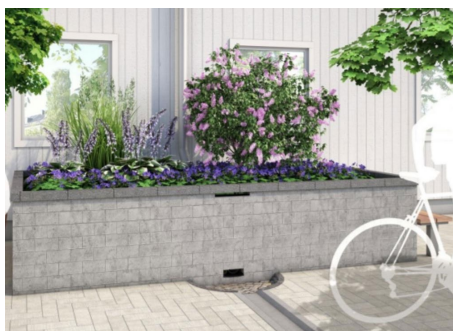
Bild 10: Exempel på upphöjd växtbädd som tar emot dagvatten från tak via stuprör. Bilderna är hämtade från Infrastrukturutredning Hedemora simhall, s.49
